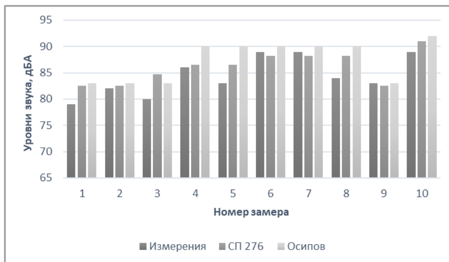
Рисунок 3– Графики с результатами натурных измерений и расчётов максимального уровня шума
